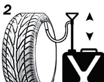
Reliez le tuyau à la valve et actionnez la pompe. Selon le modèle de pompe:
