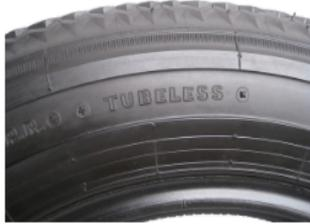
Le type de **pneus Tubeless** est aujourd'hui le plus répandu sur le marché. Le pneumatique comporte une chambre à air intégrée. Ainsi, la valve de gonflage est directement appliquée sur la jante et n'est plus collée à la chambre à air.
